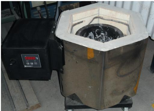
**Figura 8** Horno de crisol terminado.
