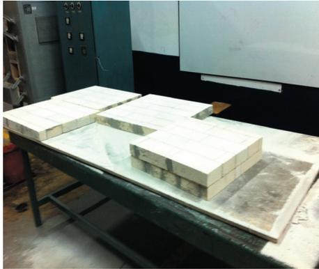
**Figura 9** Placas de ladrillo refractario
