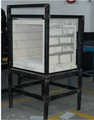
**Figura 11** Estructura metálica del horno
