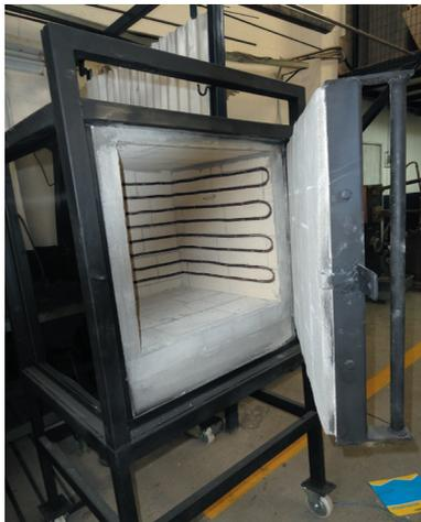
**Figura 12** Ubicación de las niquelinas en las paredes del
