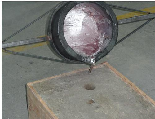
**Figura 15** Proceso de colado del metal.
