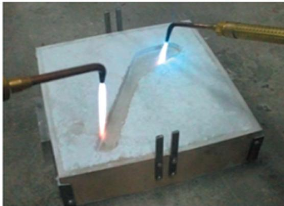
**Figura 14** Proceso de secado del molde.
