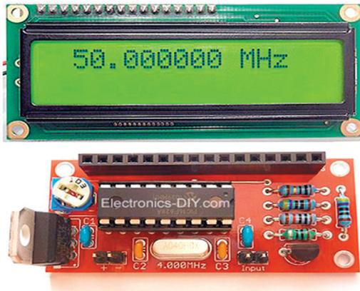
Figura 7. Frecuencímetro ensamblado
